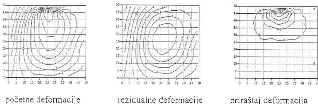
Slika 4.4. Konturne linije nosača A1
