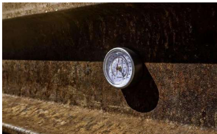
Slika 4.15 Pozicija šinskog termometra u skladu sa inženjerskom praksom [99]
