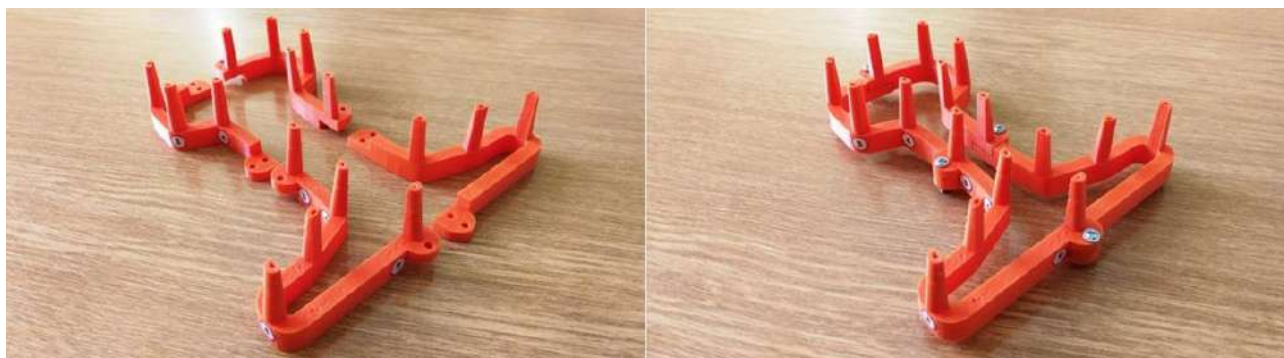
Slika 4.4 Modularni držač termistorskih senzora od PLA materijala
