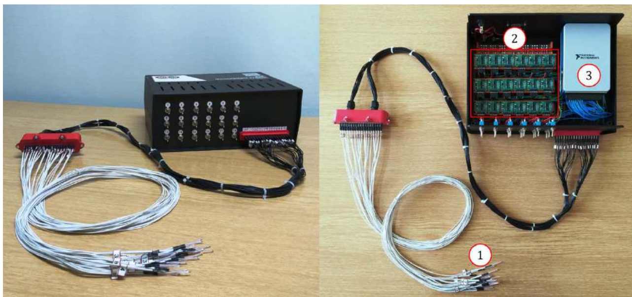
Slika 4.1 Merni sistem za merenje površinskih temperatura šine (levo) i njegove osnovne komponente (desno) [10]
